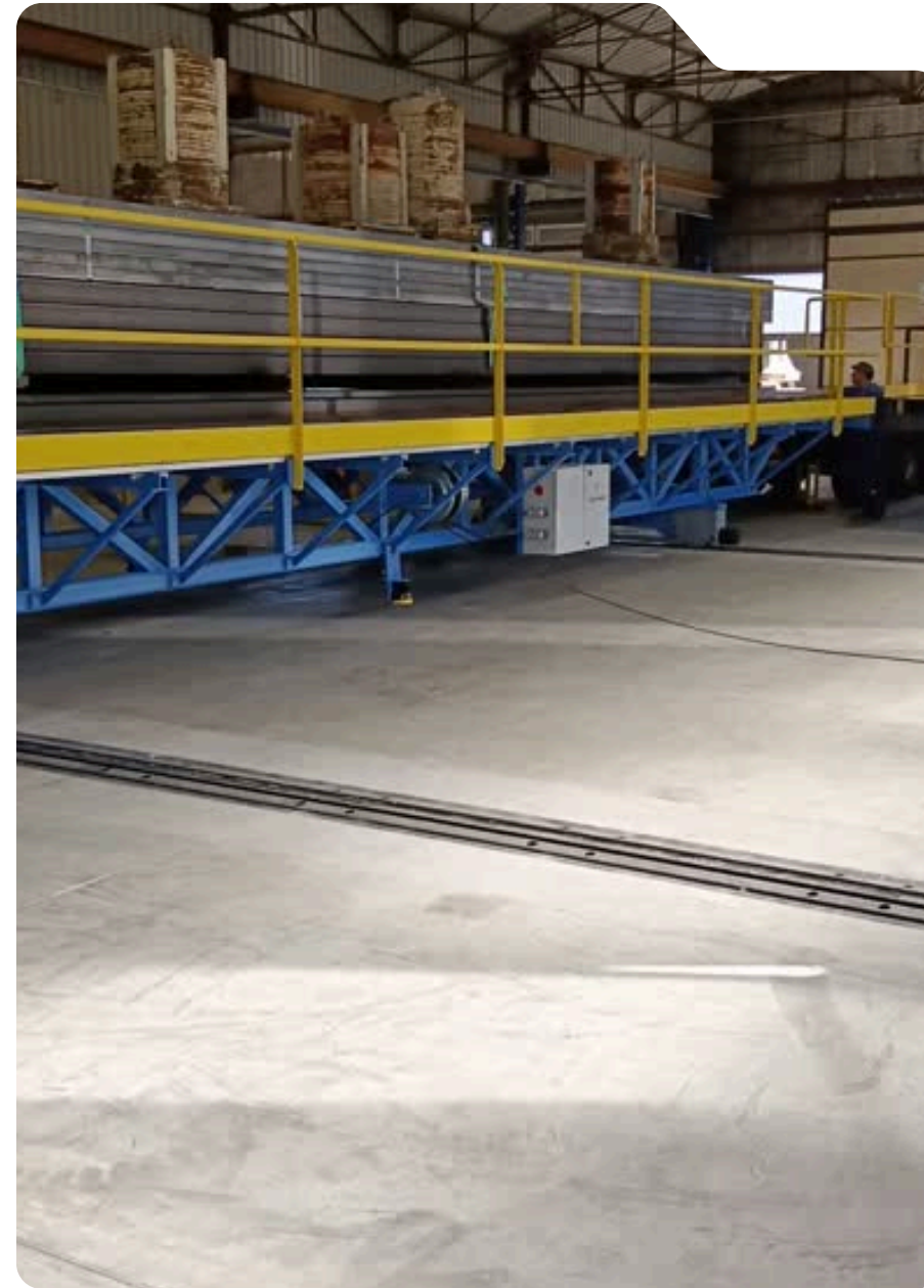
PLATAFORMA CON SISTEMA DE DESPLAZAMIENTO AUTOMATIZADO
