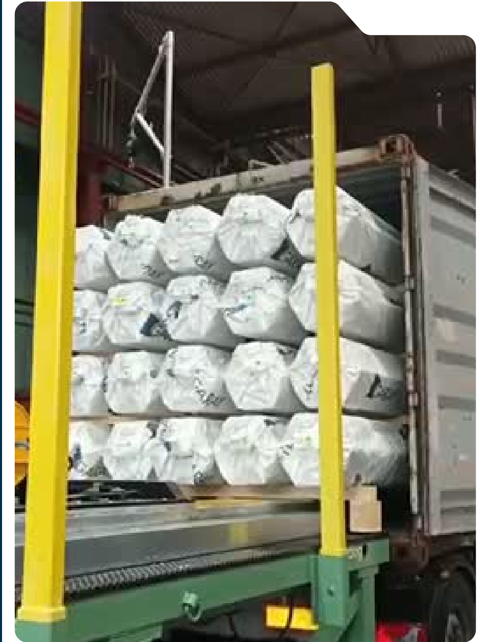
PLATAFORMA FIJA (DESCARGA SOBRE CAMIÓN)
